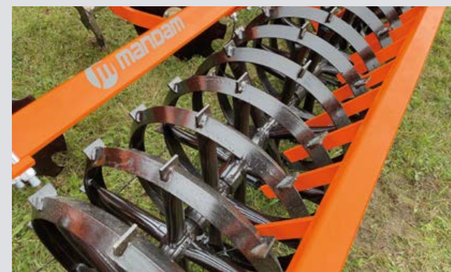
WAŁ DASZKOWY (V-RING) Z ZABIERAKAMI Ø 600 MM
