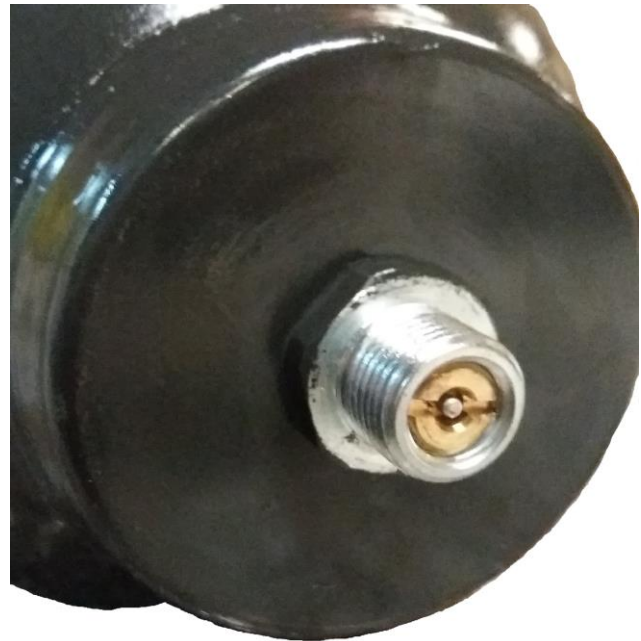
Widok zaworu regulacji ciśnienia
