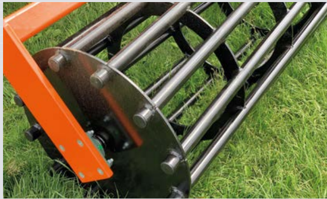
TUBULAR ROLLER D=620 MM
